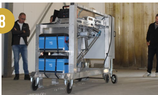
Andela Robot Weeder: machine van Andela Techniek & Innovatie die onkruid automatisch, aan de hand van beelden en een algoritme, herkent en wiedt met een robotarm. Machine draait reeds bij akkerbouwers;
