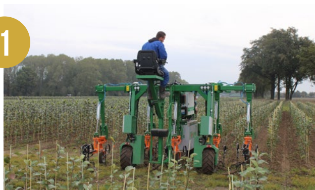
Agrimotor: volledig elektrisch aangedreven portaal-trekker van Coenders Lottum en Fleuren;
