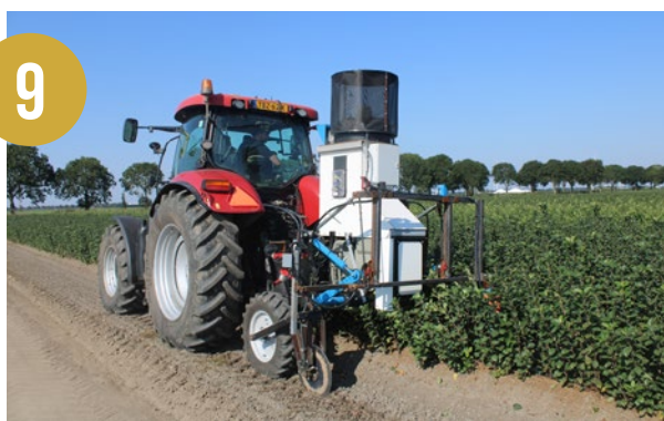
Andela Electro Weeder: doodt onkruid met een hoge stroomstoot. Deze innovatie wordt nu in de praktijk van uien en biologische bloembollen getest.
