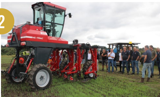
Torq HC-Trac: portaaltrekker van OC Group met onder andere Busa (horizontaal roterende schoffels uit Hongarije) eraan die in praktijk is bij Verbeek;
