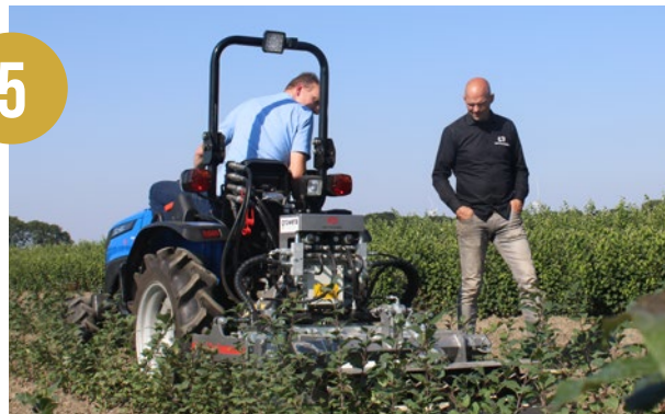
Weed Profi: modulaire schoffelmachine van OdV Techniek uit de laanbomen, gekoppeld aan smalspoortrekker en apparatuur aan portaal-trekker van Botden;
