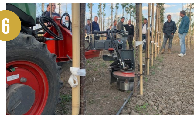
Weedetele: bodemvolgende rotorschoffels van Van Tuijl Innovations uit de laanbomen, gekoppeld aan smalspoortrekker;
