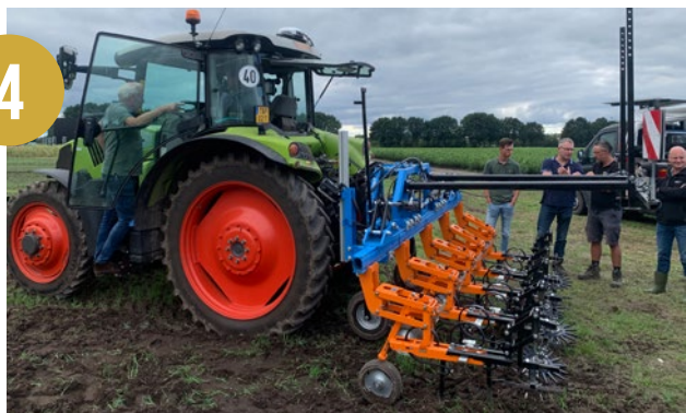
Cameragestuurde schoffelmachine van het Duitse Schmotzer die reeds door kwekers van laurier en Taxus wordt gebruikt;
